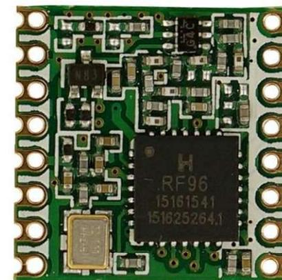
Figure 17: HopeRF RFM96 LoRa module
